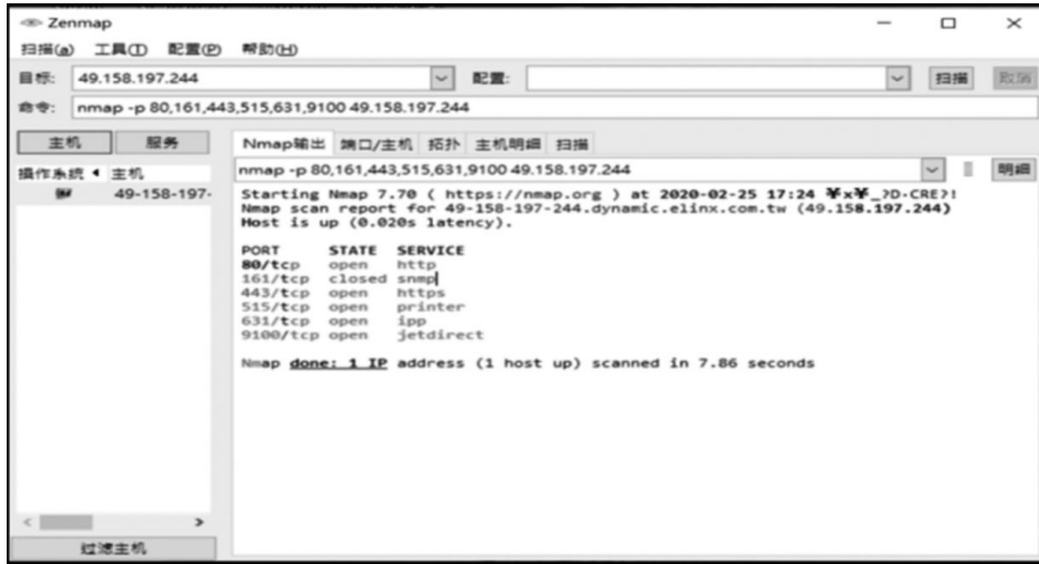
圖 2(c). Nmap 查詢 9100 埠的連線狀態
